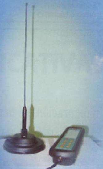
Ampliación del receptor con una antena omnidireccional para rastrear desde el vehículo
